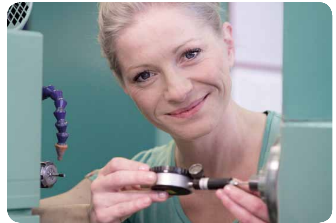
Maßkontrolle beim Schleifprozess
