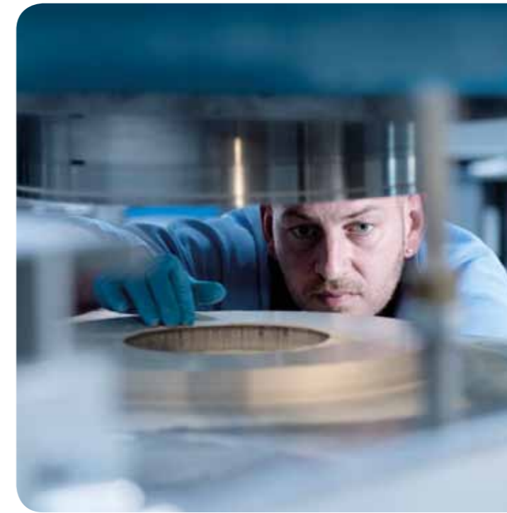
Rechts: Kontrolle der Ringhöhe beim uniaxialen Pressen - 3D-Vermessung mit Koordinatenmessmaschine
